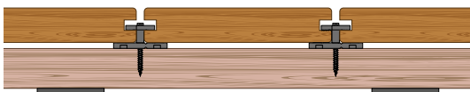
IP-4 Ipè (25x140 mm) installation with symmetrical milling and RemoClip Ipè 25x140 mm pose avec fraisage symétrique et RemoClip
